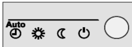
Mit der Taste kann zwischen den einzelnen Betriebsarten gewechselt werden. Die Wahl wird im Display durch Balken unterhalb der Heizbetriebs-Symbole angezeigt.
