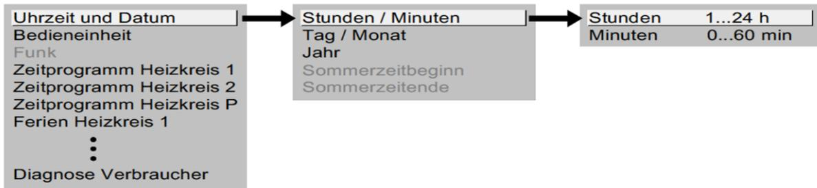
Einstellungen, die nicht direkt mit Bedienelementen bedienbar sind, werden in Programmierung vorgenommen. Dazu sind die einzelnen Einstellungen in Bedienseiten und Bedienzeilen gegliedert und damit zu zweckmässiger Gruppen zusammengefasst. Das folgende Beispiel zur Einstellung der Uhrzeit und Datum soll dies veranschaulichen.
